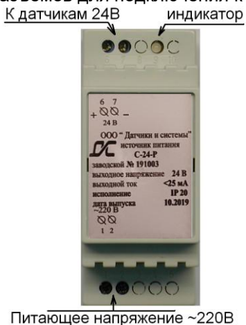
Рис. 1 – расположение разъемов ИП.
